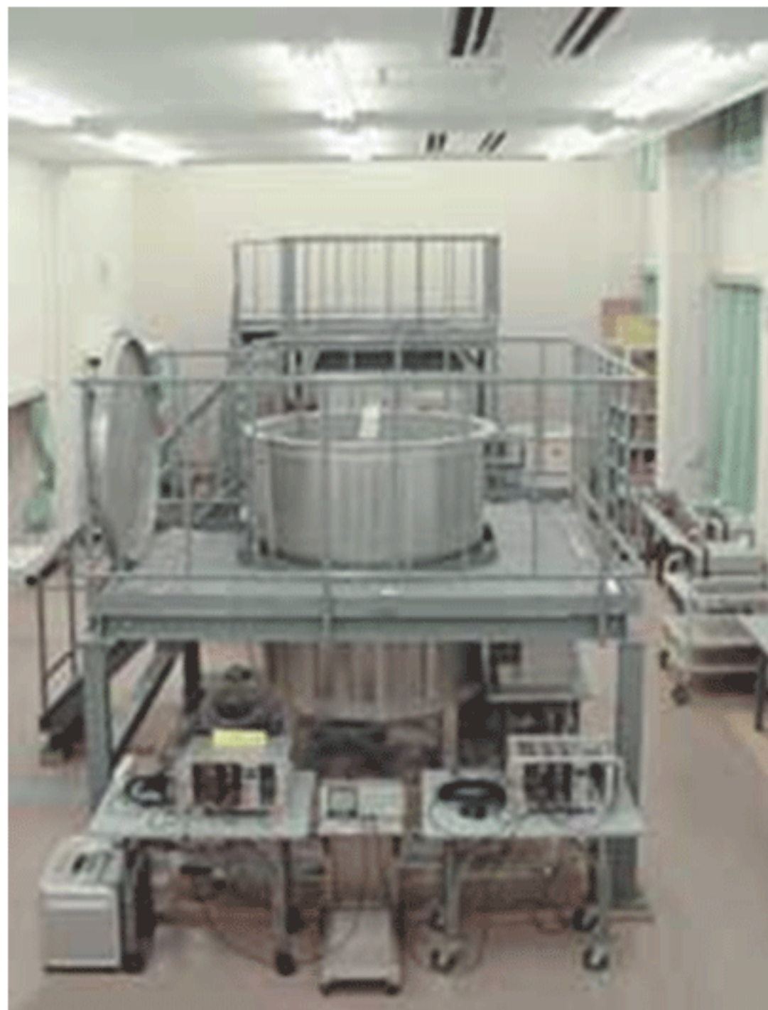
図4 指数実験装置と移動面積測定装置
