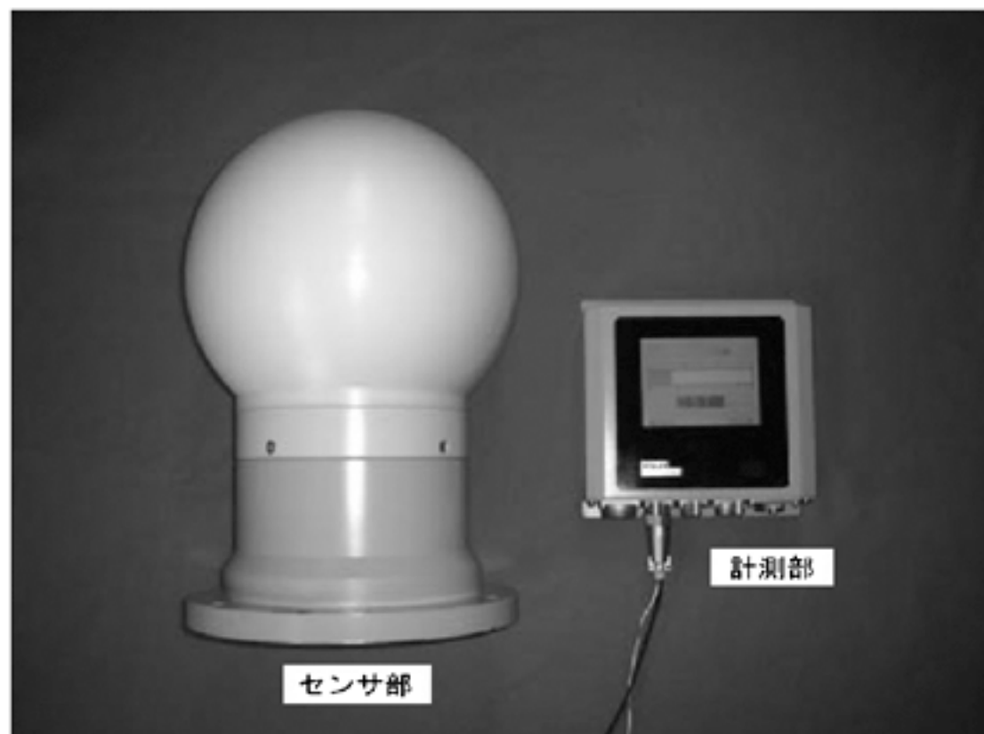
b) 放射線モニタの例 (中性子線エリアモニタ)
