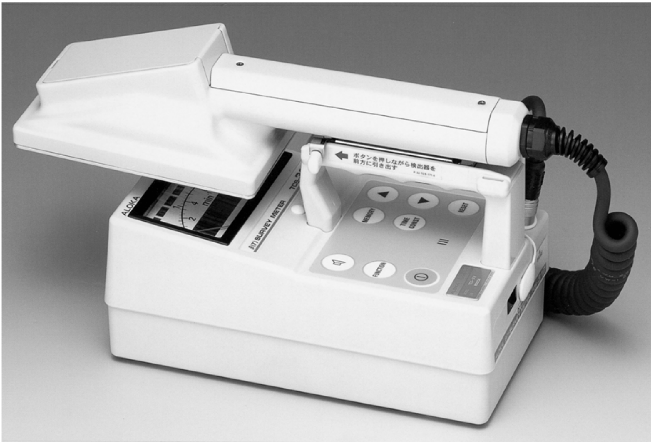
図1 表面汚染測定用サーベイメータの例
