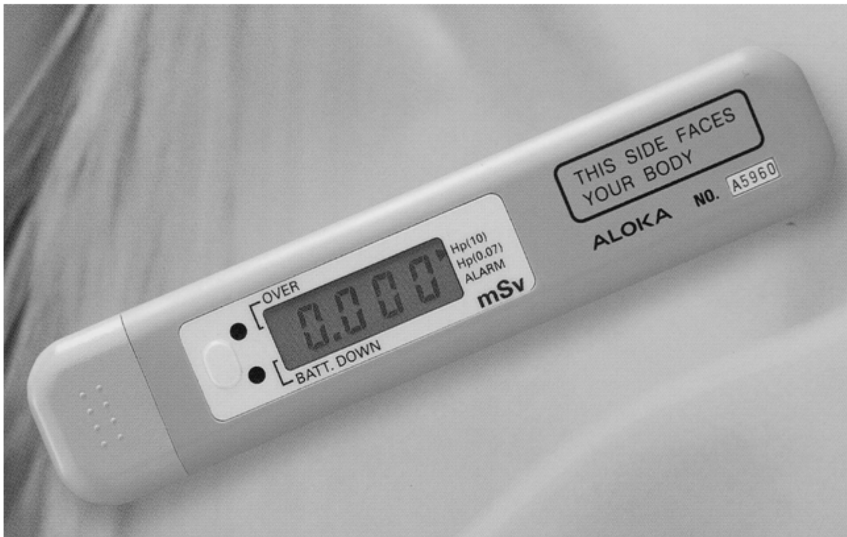
図4 電子式線量計(一般向け)の例
