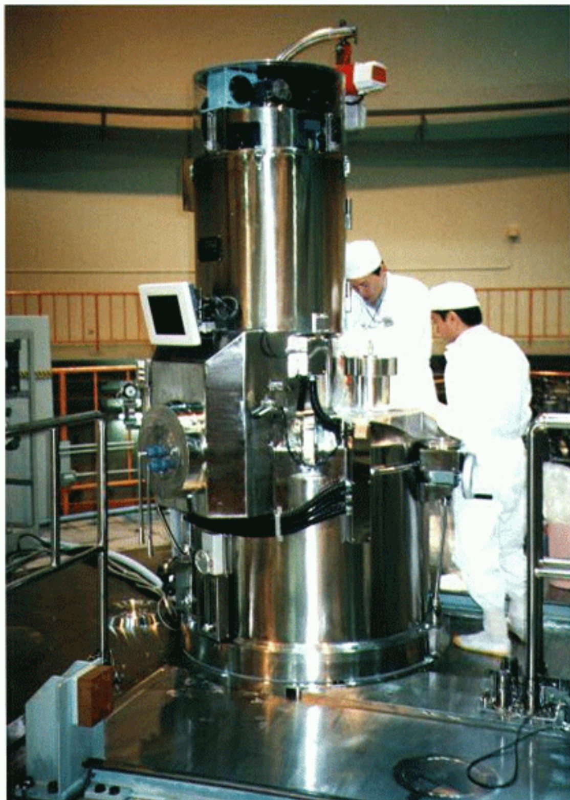
図6 JRR-3Mに設置されているシリコン照射装置
