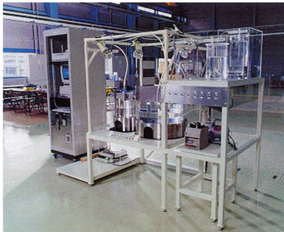
図8 緩衝材流出挙動試験設備 (BENTFLOW I)
