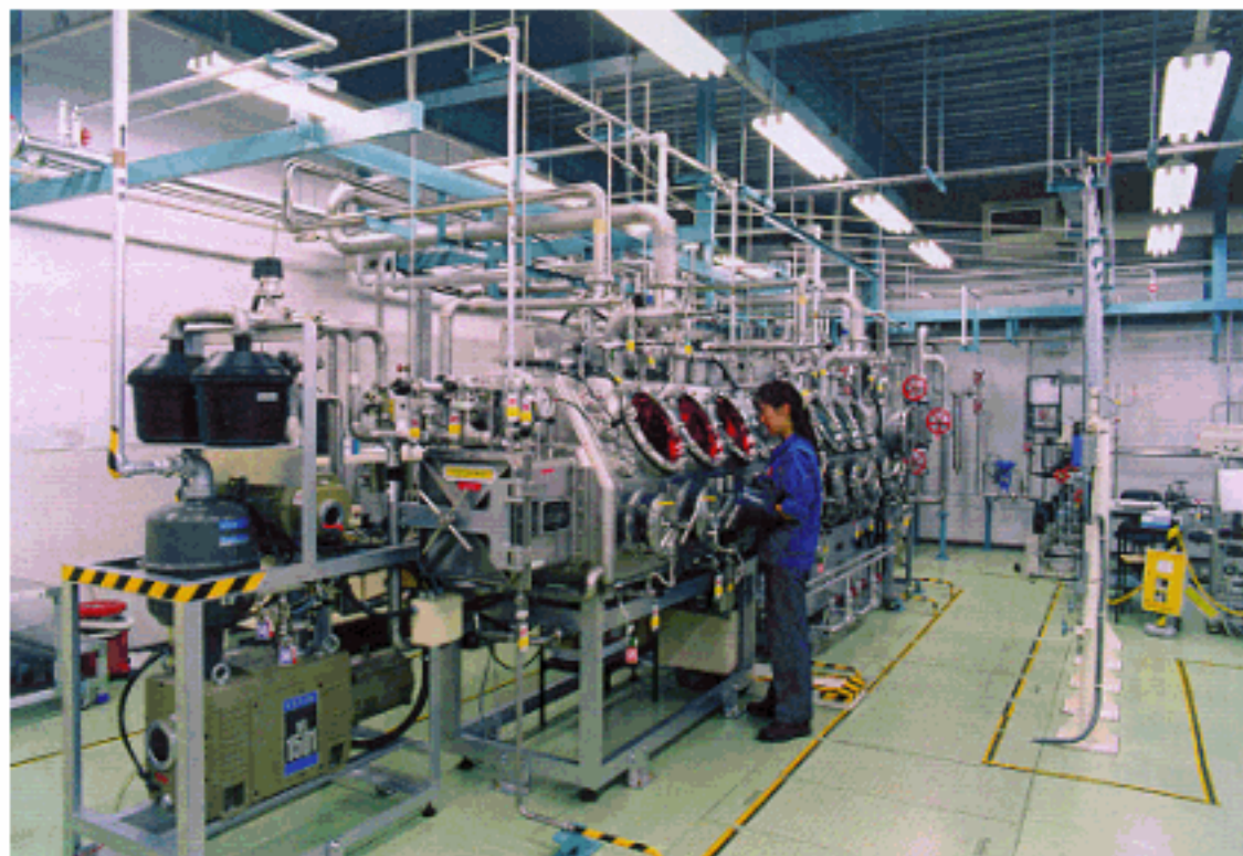
図2 化学平衡反応試験設備(EDAS II)
