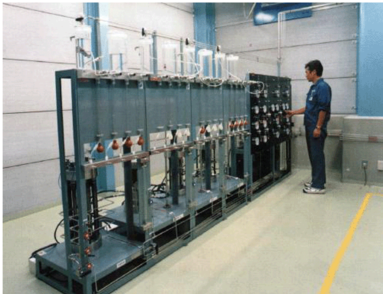
図7 水素ガス移行挙動試験設備
